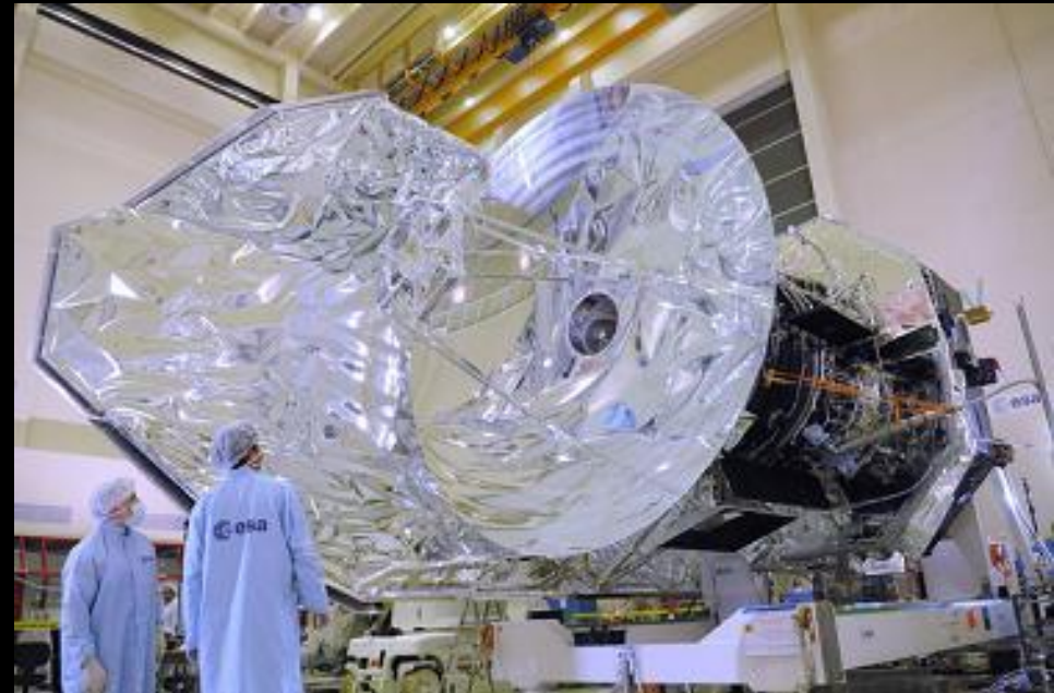
Vue générale – optique Cassegrain et baffle thermique au premier plan
